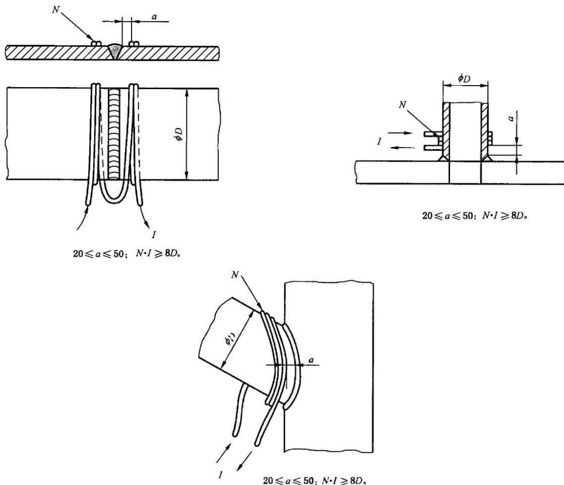
**说明：** $N$ ——匝数； $I$ ——电流(有效值)； $a$ ——焊缝与线圈或电缆之间的距离。
